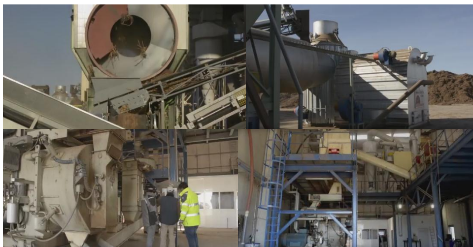
Figura 3.5 Attrezzatura utilizzata da Pelets de la Mancha (Athisa Group) per gestire le potature dei vigneti. Sopra, a sinistra: il tramaglio utilizzato per separare le frazioni più grosse da quelle più sottili. Sopra, a destra: essiccatore rotativo. Sotto, a sinistra: dettaglio dell'unità di pellettizzazione. Sotto, a destra: impianto di trasformazione. Fonte: video commerciale di Pelets de la Mancha (Athisa Group) disponibile su YouTube
