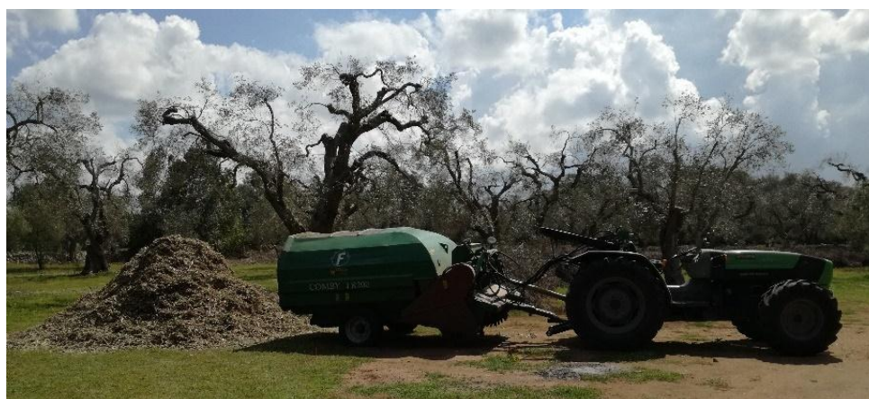
Figura 4.1 Una trincia - raccoglitrice integrata FACMA TR200, uno dei principali attrezzi utilizzati per l'approvvigionamento della biomassa dalla FIUSIS. Fonte: CERTH.
