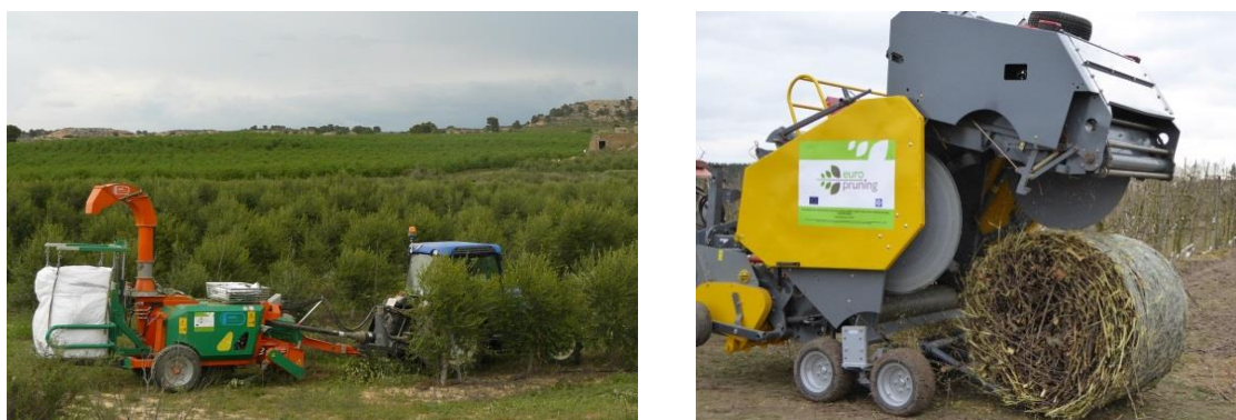
Figure 22: Dos ejemplos de nuevas soluciones desarrolladas por los proyectos EuroPruning: La astilladora ONG-SNC (izq.); Empacadora cilíndrica PIMR PC50 (derecha).
